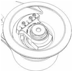
3. Mašinos konfigūracija naudojant be disko apsaugos ar sąsajos.
