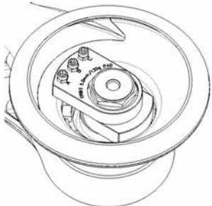
2. Masina konfiguratsioon kaitseketta/vahetallaga kasutamisel.
